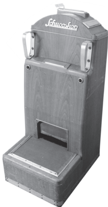
Røntgenapparat til fødderne, et såkaldt pedoskop, som man stadig i 1970'erne kunne finde i skobutikker rundt om i Tyskland.
